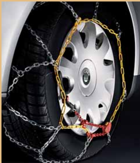
Hólánc 15"-os keréktárcsához és 195/65 R15 gumiabroncshoz (CEP 300 002A) Hólánc 16"-os keréktárcsához és 205/55 R16 gumiabroncshoz (CEP 300 003)
