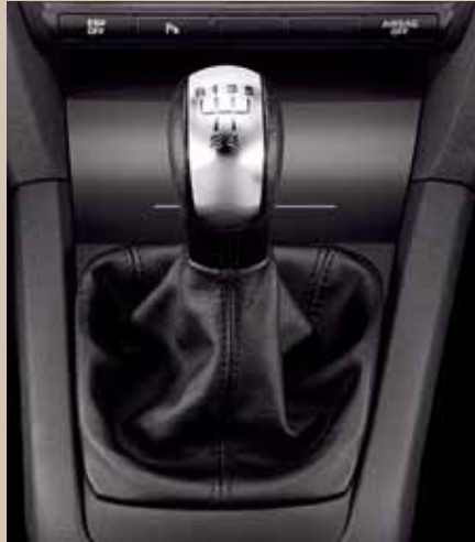
Bőr sebességváltógomb (FFA 600 001 az 5 sebességes váltóhoz, FFA 600 002 a 6 sebességes váltóhoz) Bőr sebességváltókar-borítás (FBA 600 001)
