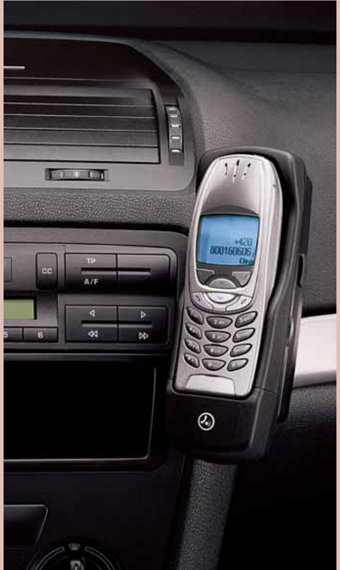
Műszerfalra szerelhető mobiltelefon-tartó (ATC 600 001-0XX – a telefon típusától függően)
